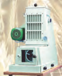
小型实验磨粉机 Quadrumat® Junior 制粉
